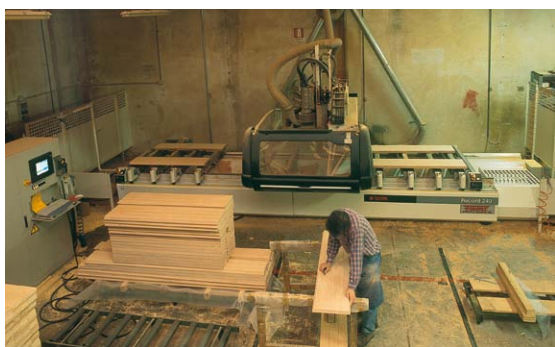
Centro di lavoro a C.N.C. Record 240 S.C.M. "Lavorazione a Pendolo" L'operatore carica la macchina e collauda le ante
