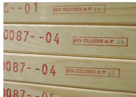
Il collaudatore sigla l'anta con il suo numero di matricola e dà l'OK per l'imballo e la spedizione
