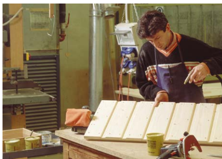
Dopo la levigatura eseguita con macchina a 3 nastri, ogni anta passa al controllo e collaudo
