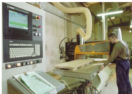
Le ante vengono "sbattentate" al pantografo
