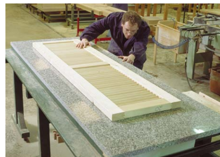
Le ante all'uscita dallo strettoio vengono posate su un piano in marmo per il controllo della planarità
