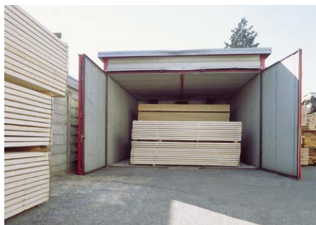
Siamo dotati di forno ad aria calda per l'essiccazione del legno con capacità di m 3 35 a ciclo per complessivi 140 m 3 mese
