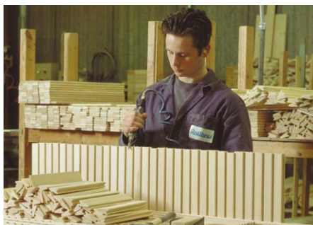
Ogni singolo componente viene controllato "a vista" prima di passare all'incollaggio
